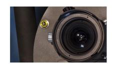
وتعتمد فكرة عمل هذه العدسات على أنها يتم تصنيعها بحيث أنها تصحح معامل الانكسار للضوء تحت الماء فانتجت شركة Nikon عدسات مائية تستخدم في التصوير تحت الماء ، وهي عدسات نيكونس Nikonos الأكثر شيوعاً ، ومنها ما يستخدم تحت الماء فقط ونوعية آخرى يصلح للاستخدام تحت الماء و
