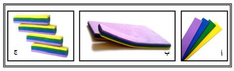
شكل رقم (1) يوضح طريقة الحصول على وحدات النيرياج بشرائح اللدائن الصناعية
