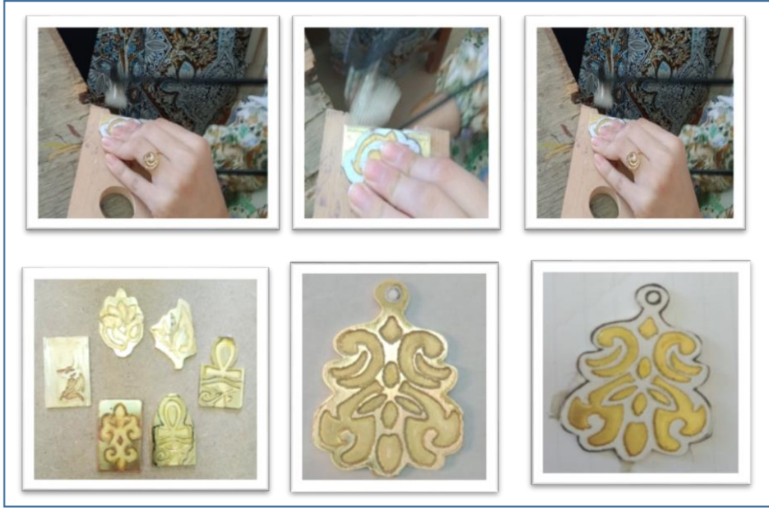
شكل (١٧) مرحلة تنفيذ النشر واعداد المشغولة للبرد والتشطيب للحواف
