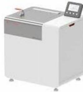
صورة (١٢) جهاز اختبار ثبات اللون للغسيل المتكرر
