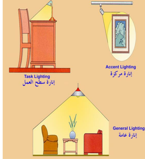
توضح الصورة رقم ( 4 ) انظمة الاضاءة المختلفة
